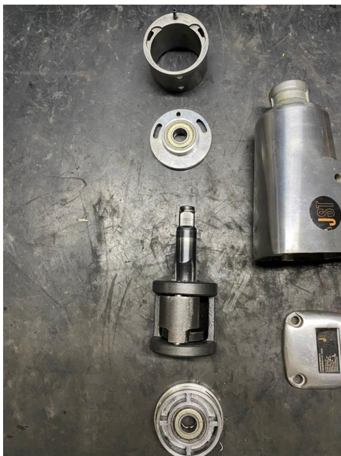
Imagem 2 – Detalhe do sistema de impacto do tipo Rocking Dog.
