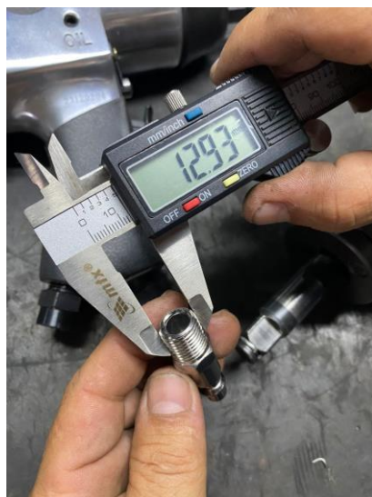
Imagem 4 – Medição do pino de entrada de ar.
