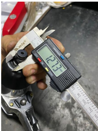
Imagem 3 - Medição do pino de entrada de ar.
