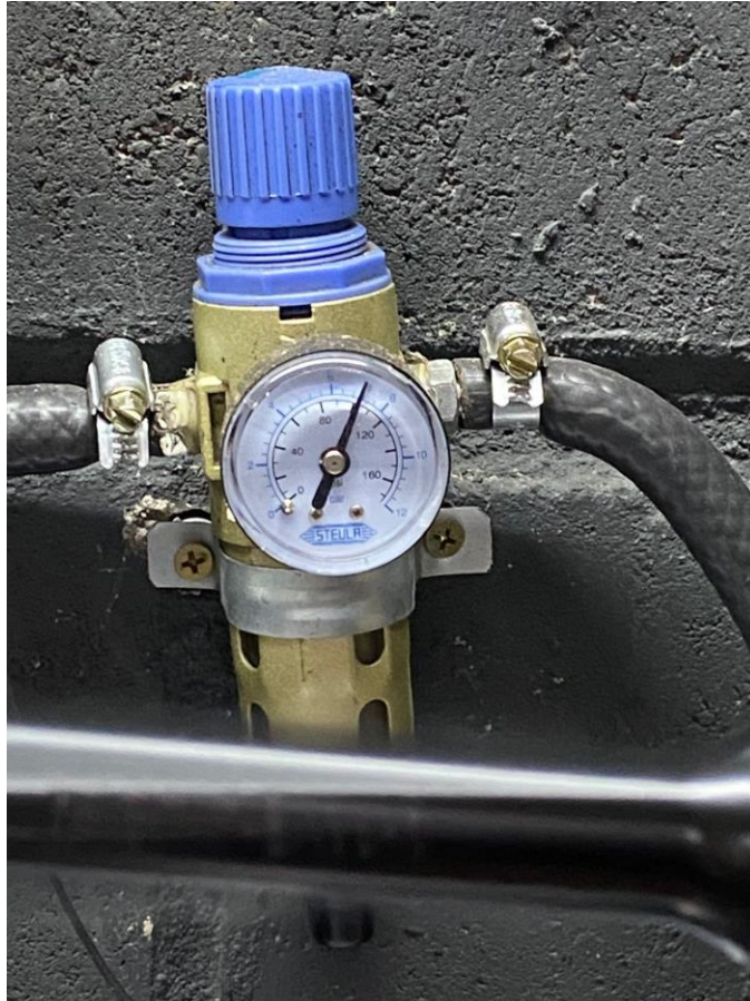
Imagem 8 – Aferição e regulação do manômetro em 90 psi.
